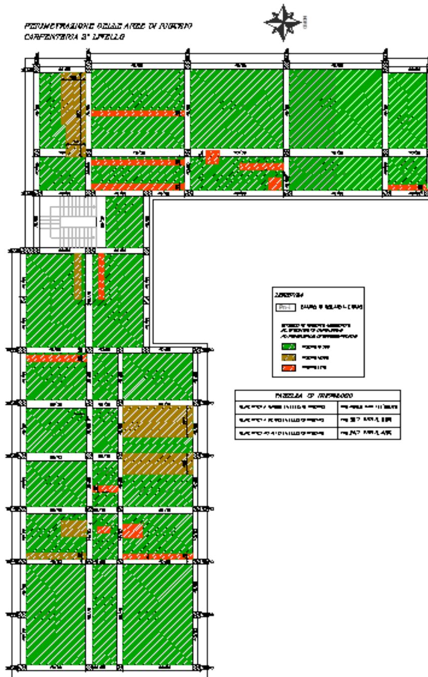
Figura 17 - Esempio di perimetrazione e classificazione delle aree a rischio.
