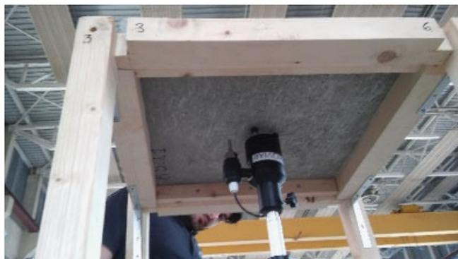
*Fig. 17. Test acustico sperimentale su piastra in c.a.*
