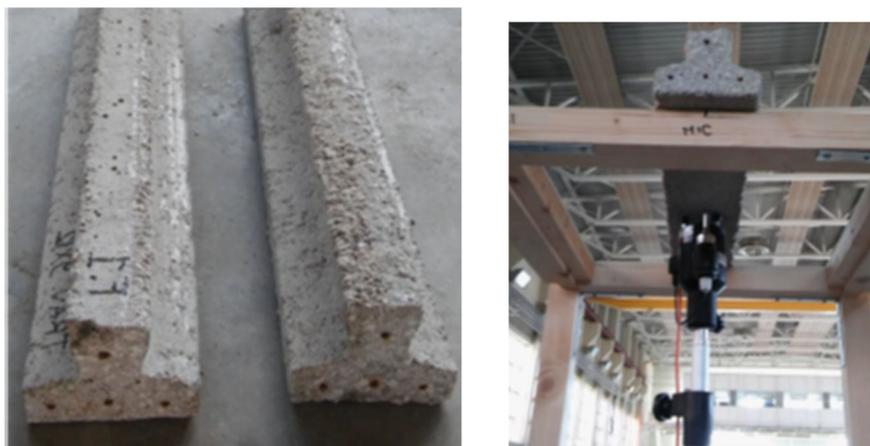
Fig. 27. Prototipi travetti e sistemazione su supporto per prova sperimentale S.E.S. Travetto c.a.p. – 9x12 cm (TAG: F.1, F2).
