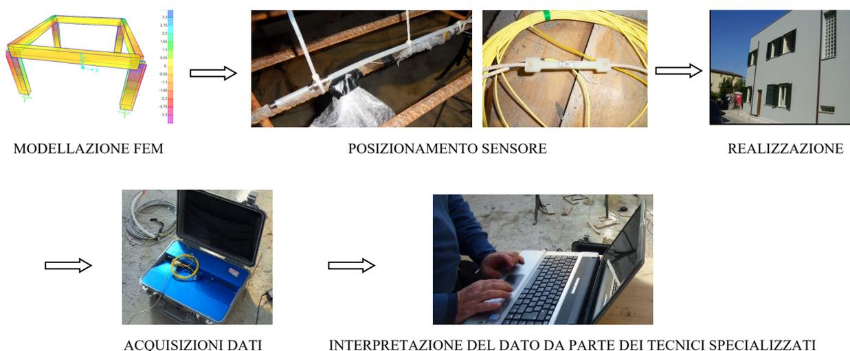
Fig. 1 – Schema tipo di un sistema di monitoraggio statico.
