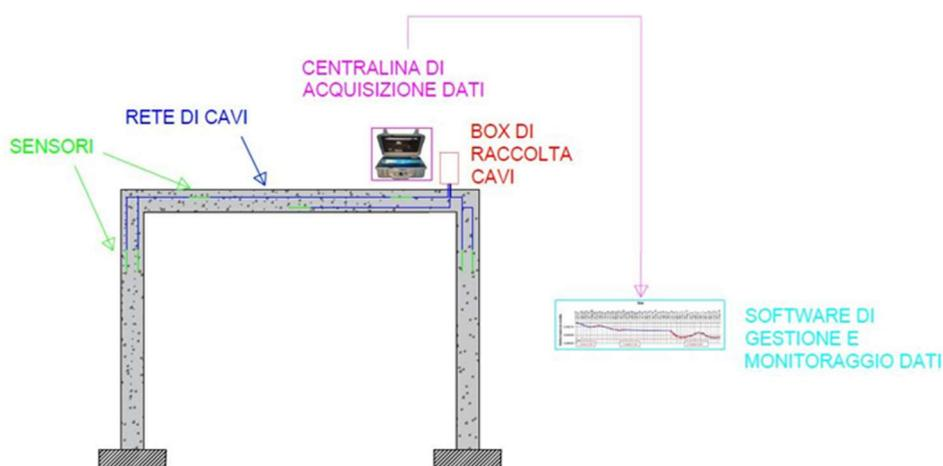
Fig. 1. Schema di sistema di monitoraggio statico
