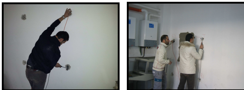
Figura 7. Ejemplo de medición del eco producido por impacto.
