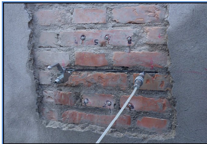
Fig. 7 – Prova a martinetto singolo
