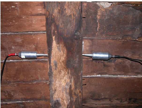
Fig.3 – Strumento ad ultrasuoni per il legno
