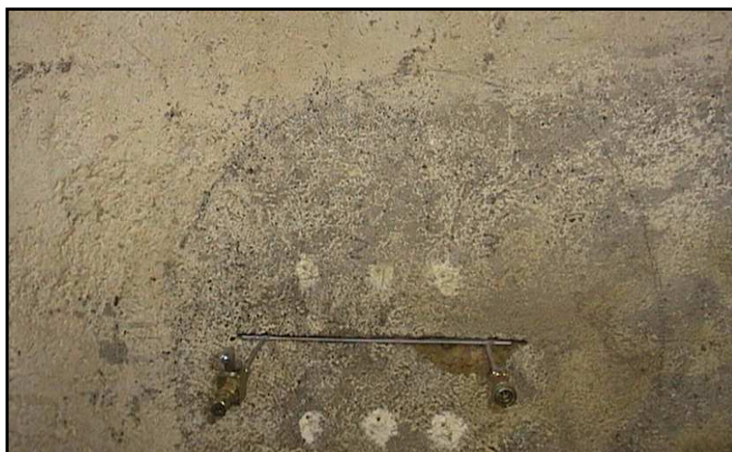
Figura n°7 – Prova a martinetto singolo
