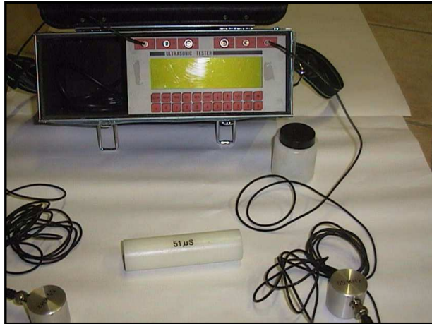
Figura n°5 – Strumentazione ad ultrasuoni
