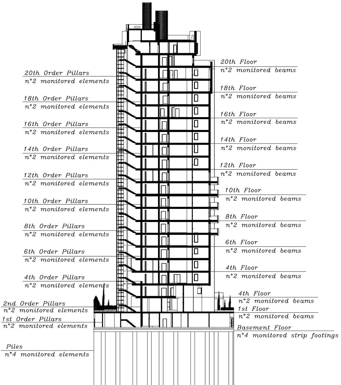
**FIG. 4 MONITORED BEARING ELEMENTS**
